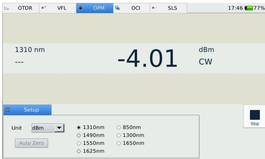
Rys. 16.1 Moduł optycznego miernika mocy
